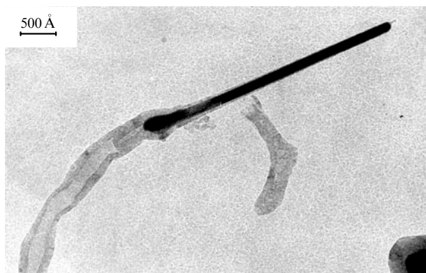
Рис. 11. Микрофотография нитевидного углерода, образовавшегося из метана на катализаторе Ni – Cu/Al 2 O 3 при температуре 973 К.
