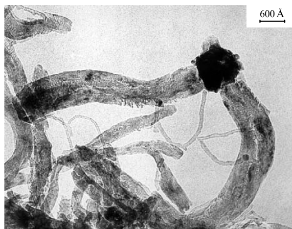
Рис. 7. Морфология углерода, образующегося из метана на блочной частице сплава Ni–Cu после 5 мин реакции при температуре 873 К.
