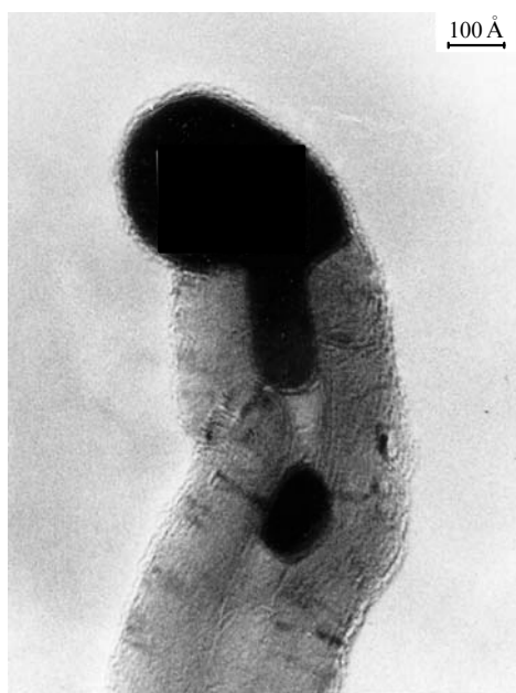
Рис. 5. Микрофотография, полученная методом электронной спектроскопии высокого разрешения (ЭМВР), углеродной нити, образовавшейся на металлическом железе в среде бензола, разбавленного аргоном в мольном отношении C 6 H 6 :Ar = 1:15, при температуре 923 K. 77
