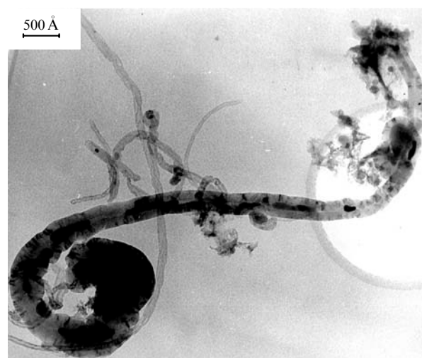
Рис. 9. Микрофотография нитевидного углерода, образовавшегося из метана на катализаторе Ni/Al 2 O 3 при температуре 1023 К.
